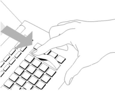
Alle Funktionstasten sind schon standardmäßig mit häufig verwendeten Funktionen belegt. Neben den Funktionstastenreihen können Sie die dazugehörigen Beschriftungstreifen einlegen. Diese befinden sich auf dem mitgelieferten Blatt.
