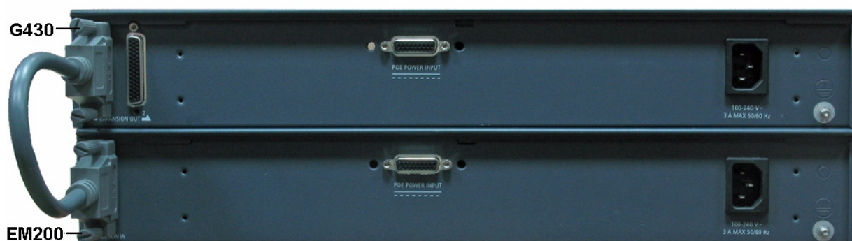
图 5：将 EM200 连接到 G430
